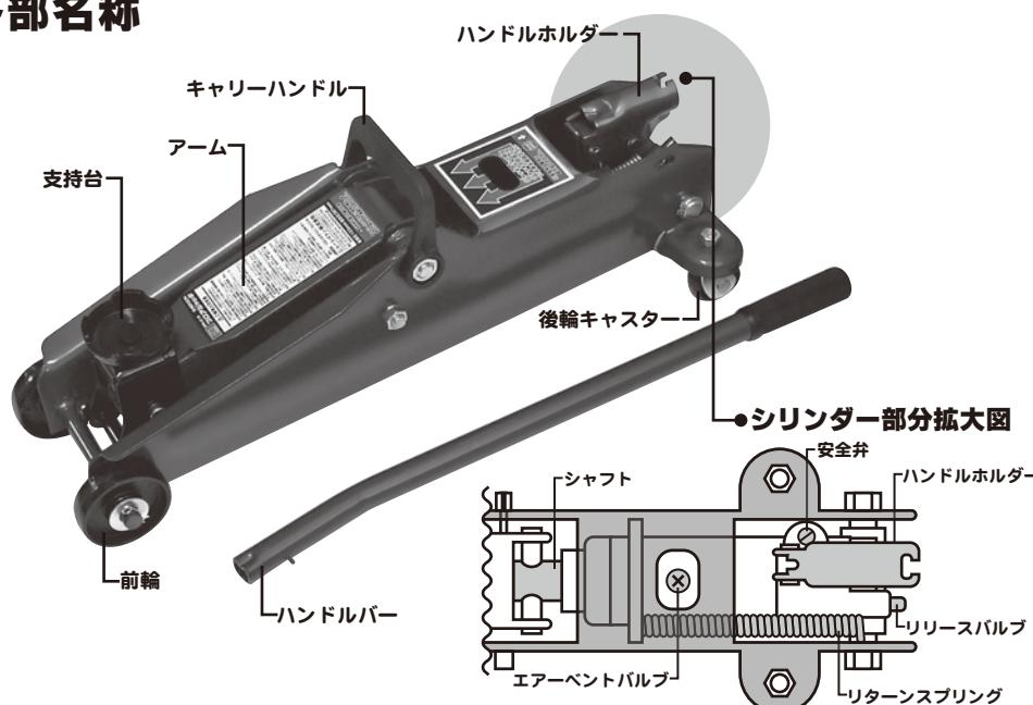
※安全弁は絶対に回さないで下さい。工場での生産時、オーバー荷重を防ぐために調整されています。
