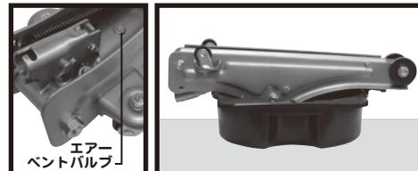
③<オイルの補充>の手順②～④に従って新しい油圧用オイルを注入し、カバープレートをピンで取付けて下さい。
